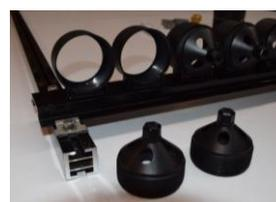
Montieren Sie die 4 Kollektor-Haltewinkel in die Kollektor-Profilschienen und montieren Sie die Kollektormodule auf den bereits montierten Profilrahmen. Beachten Sie, dass Sie die unteren Haltewinkel noch nicht fest anziehen, damit die Module noch seitlich verschoben werden können
