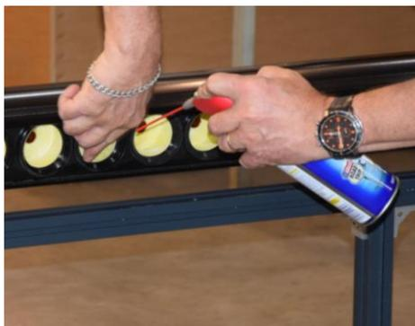
Montieren Sie nun alle Röhren und sichern Sie jede Röhre unten mit den Kunststoffabdeckkappen gegenüber abrutschen. Dabei reicht es, wenn die Abdeckkappe von Hand angezogen wird.
