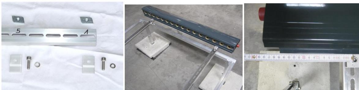
Zur Montage der Fußschiene schrauben Sie die Klemmhalter in der 1. und 3. Lochung im unteren Teil der beiden Schienen lose an. Verwenden Sie hierfür jeweils eine Inbusschraube M8 x 25, einen Federring M8, einen Klemmhalter und eine Schiebemutter. Danach die Fußschiene auflegen, linke und rechte Röhre einsetzen und Sammlerkasten und Fußschiene parallel zueinander ausrichten. Anschließend die Klemmhalter an den Seitenschienen festschrauben.
